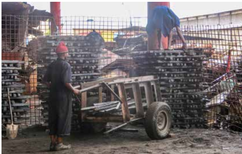
Når metallstenger skal flyttes, kastes de ned i en tralle; lyden av smellene er rundt 92dB(A), om man måler like ved aktiviteten. Foto: B.E. Moen
